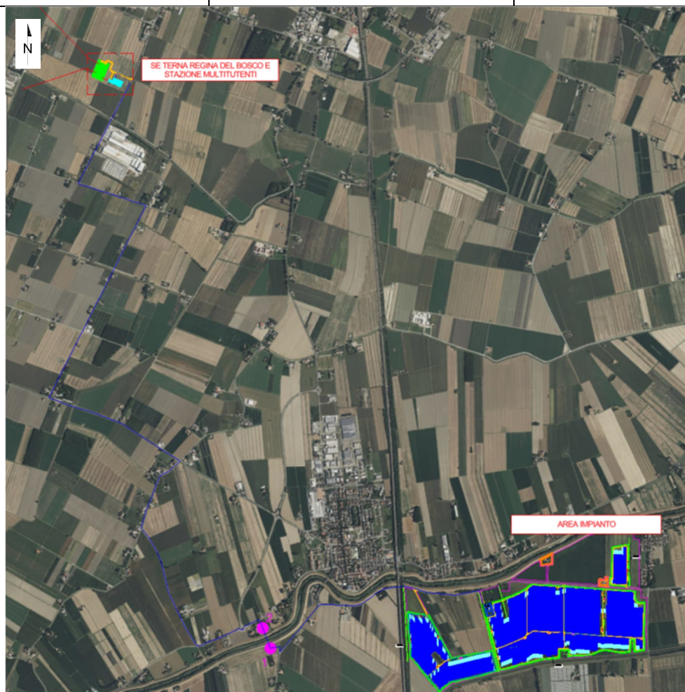
Figura 6 - Dettaglio sul collegamento tra la cabina di raccolta e la S.E. Terna Regina del Bosco. In blu è indicato il cavidotto di connessione.
